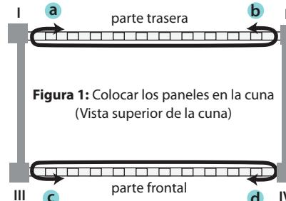
**Figura 1: Colocar los paneles en la cuna**
